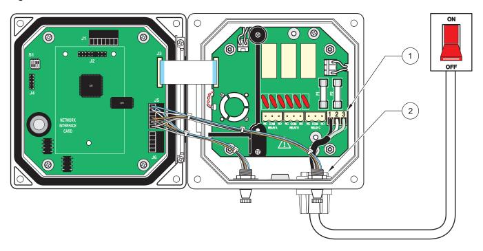
1. Power terminal 2. Conduit strain relief
